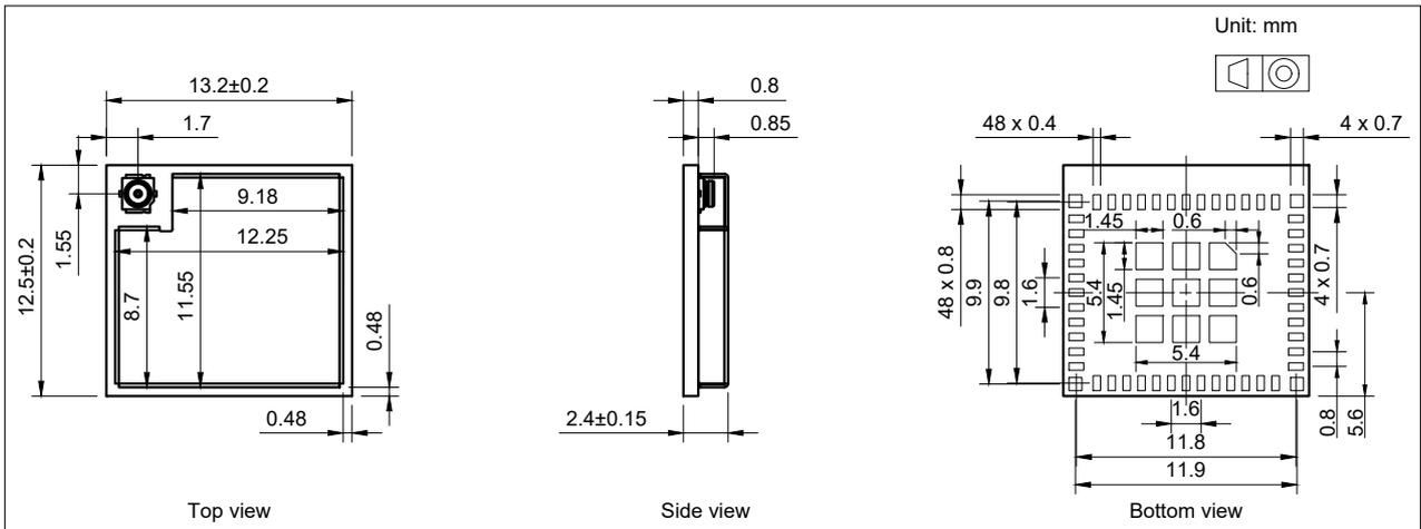
图 9: ESP32-H2-MINI-1U 尺寸
