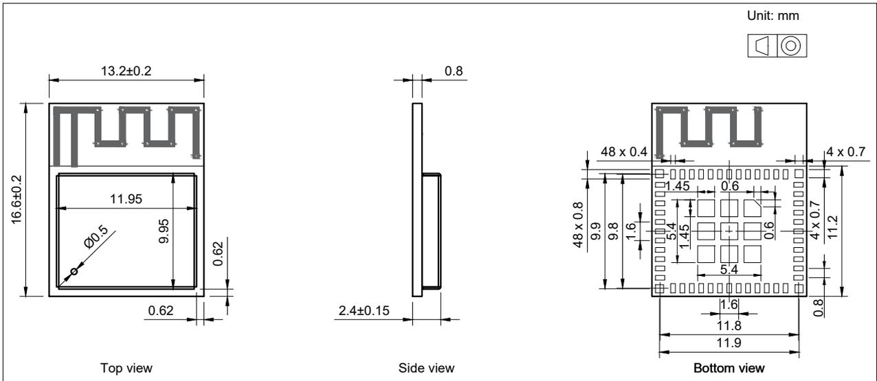
图 8: ESP32-H2-MINI-1 尺寸
