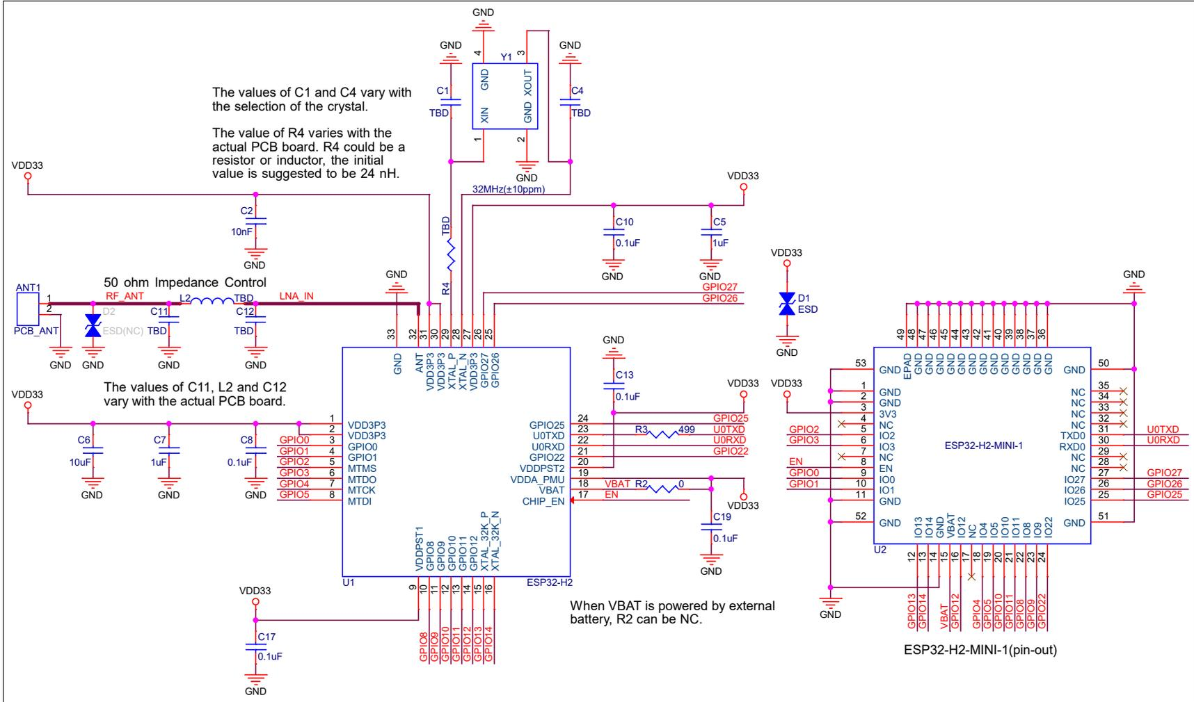
图 5: ESP32-H2-MINI-1 原理图
