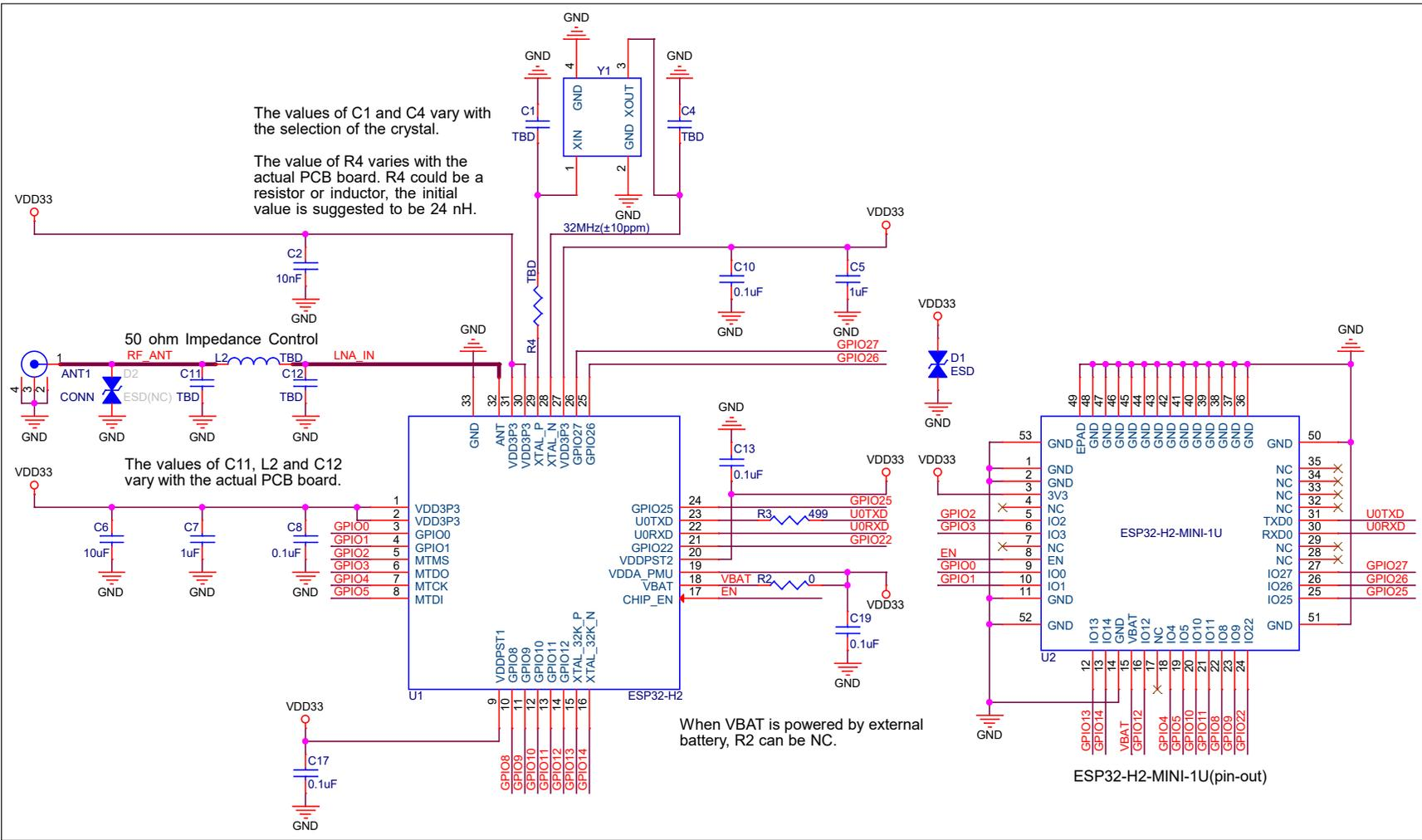
图 6: ESP32-H2-MINI-1U 原理图
